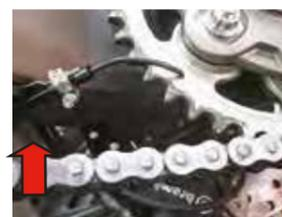
2. Fije el tubo de aceite negro (#15) al soporte menor (#17) con la abrazadera (#18). Orientar el inyector sobre la corona; debería estar entre las 6 y 8 horas (pensando en la corona como si fuera un reloj) con el lado cortado hacia fuera de la corona. Tenga cuidado de que no toque los tornillos de la corona.
