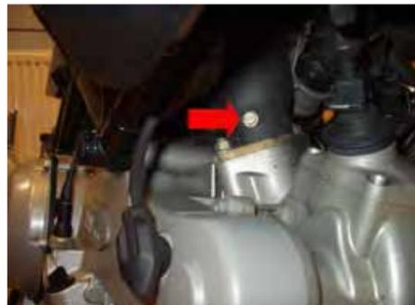
MTS 620/1000/1100 Quite el tornillo y sustitúyalo por la espita M5 (#5). Coloque el codo en la espita.
