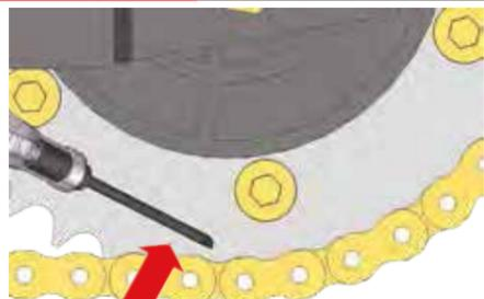
Truco: La punta del inyector debería rozar la corona, con la cara cortada orientada hacia el exterior
