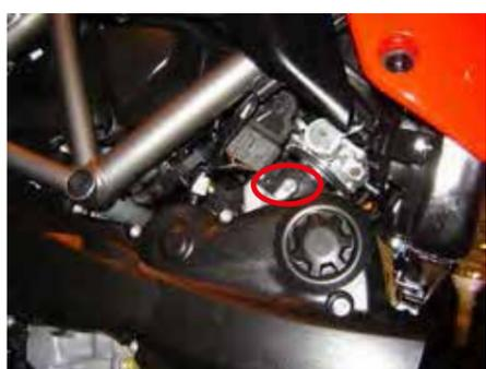
MTS 1200 hasta 2014 Quite el tornillo y sustitúyalo por la espita M6 (#6). Coloque el codo en la espita.
