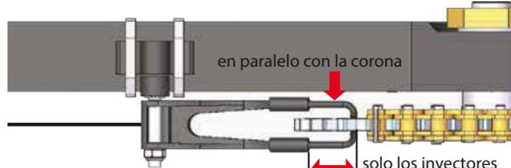
Nota. Los inyectores se pueden cortar solo los inyectores coinciden con la corona
