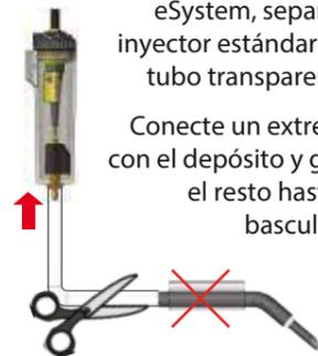
1b.) Si se va a añadir a un sistema ya instalado, eSystem o vSystem, corte el final del tubo transparente y retire el inyector estándar.
