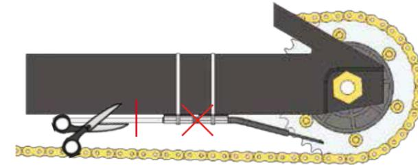
2.) Limpie la corona y la cadena y sujete el soporte (#2) del Dual Injector y el tornillo (#1) bajo el basculante.
