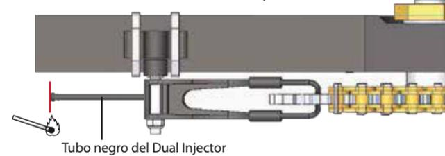
Es posible asegurar el tubo con los soportes adhesivos (#15) que se incluyen. Limpie bien la superficie y a continuación utilice la toallita con alcohol (#14).
