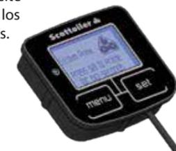
Navigate hasta la opción 'Menú de conducción'. Utilice el botón 'set' para alternar entre las opciones de flujo hasta seleccionar una gota cada 60-70 segundos. Compruebe el estado de la cadena después de una salida y ajuste el flujo si fuera necesario.
