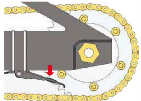
4.) Una vez que esté satisfecho con la ubicación, ajuste las bridas y corte aprox. de 10 a 12 centímetros del tubo negro que sale del Dual Injector. (Conserve el tubo para hacer recambios de los inyectores - consulte la web).
