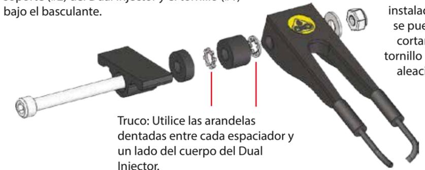
Truco: Utilice las arandelas dentadas entre cada espaciador y un lado del cuerpo del Dual Injector.
